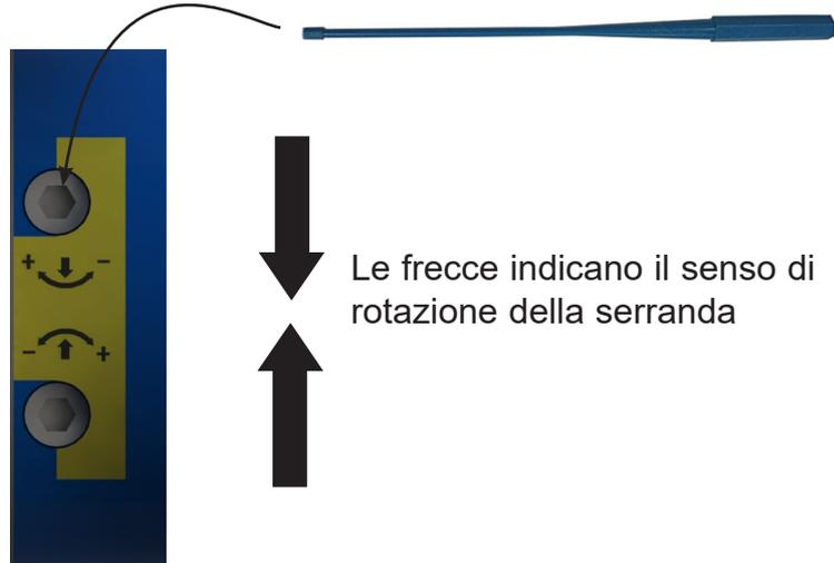
Le frecce indicano il senso di rotazione della serranda
